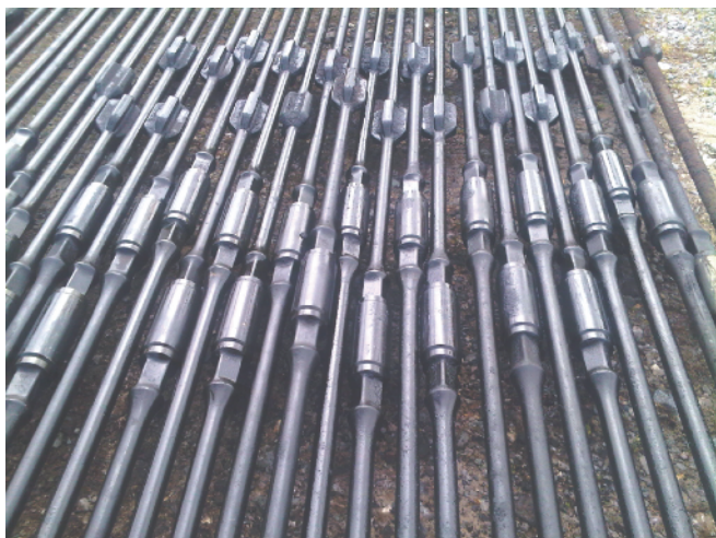
Srovnání stavu táhlic ropné sondy tři týdny po tradičním proplachu horkou ropou (nahore) a třináct týdnů po použití PRA (dole).
