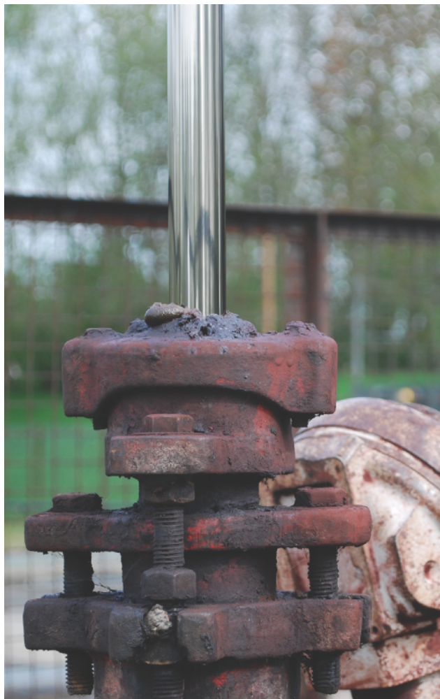
Detail táhlice a ústí vrtu krátce po ošetření přípravkem PRA.
